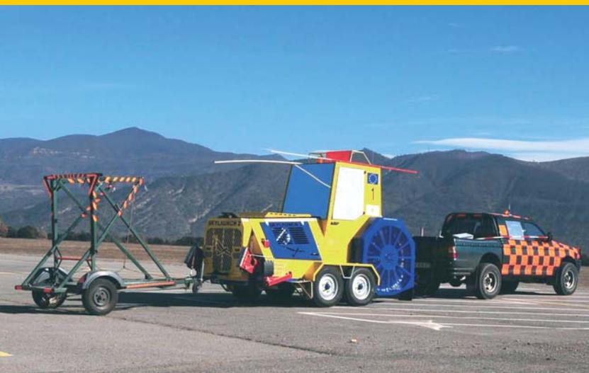
les deux nouveaux treuils exploités en parallèle permettent d'enchaîner les séquences de 4 décollages
